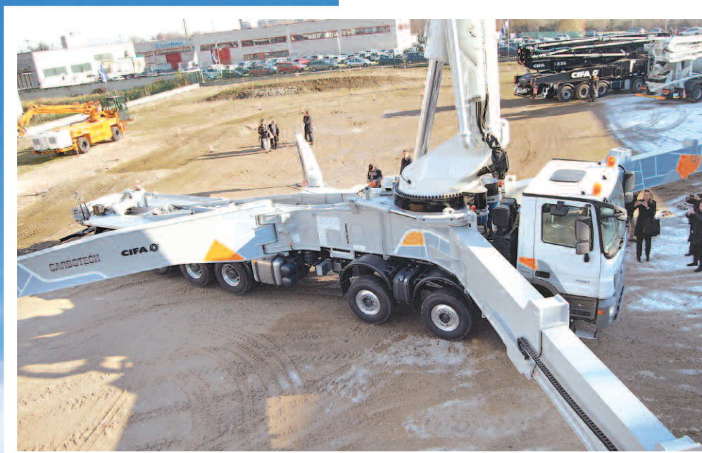
Podnoszenie osi jest aktywowane automatycznie zaraz po sygnale do wysunięcia stóp podporowych
